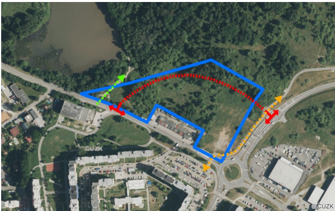
schéma znázorňující napojení na dopravní infrastrukturu (červená), křižení s pěší stezkou a cyklostezkou (oranžová) a nástupním místem pěších tras (zelená)
